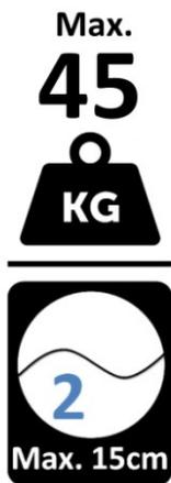
Das BEN-E-BIKE ist für den Transport einer einzelnen Person primär auf befestigten Straßen und Wegen bestimmt. Das BEN-E-BIKE kann aber auch auf geschotterten und unbefestigten Wegen bewegt werden. Es darf in rauem Terrain zum Verlust des Bodenkontakts der Reifen kommen. Sprünge (Drops) aus einer Höhe bis max. 15cm sind zulässig.
