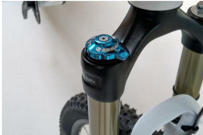
Steht der Hebel auf Linksanschlag (entgegen dem Uhrzeigersinn), so ist die Dämpfung gering. Dreht man den Hebel im Uhrzeigersinn nach rechts, wird die Dämpfung beim Einfedern immer härter bis bei komplettem Rechtsanschlag die Federgabel komplett blockiert ist ("LockOut").
