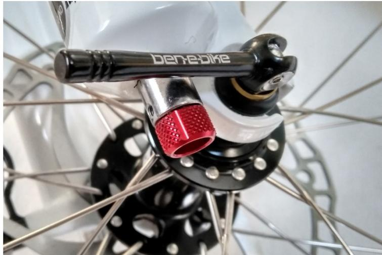
Dreht man die Rändelschraube auf Linksanschlag (entgegen dem Uhrzeigersinn), so ist die Dämpfung gering (Auslieferungszustand). Dreht man die Rändelschraube im Uhrzeigersinn nach rechts, wird die Dämpfung beim Ausfedern immer härter.
