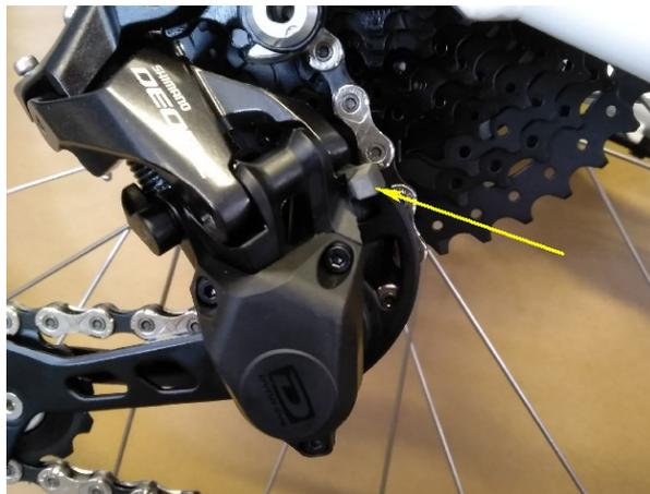
So bewirkt der Schalter eine Dämpfung des Schaltwerkträgers und damit eine Verringerung der Kettenbewegung für ein leiseres und stabileres Fahren. Mit dem Schalter in der **OFF-Position** erleichtert das Schaltwerk den Ein- und Ausbau des Hinterrads, indem die Schaltwerksfeder entspannt wird.
